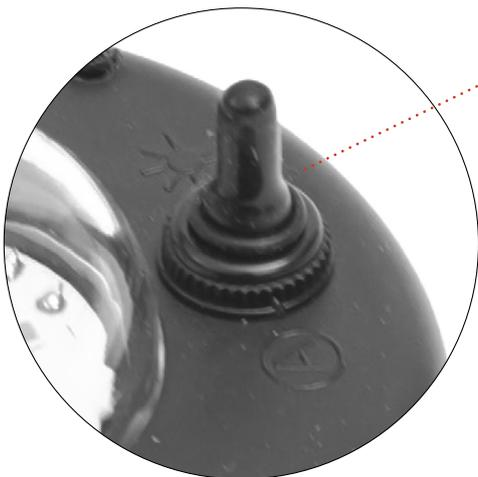
Переключатель можно использовать для 3-х настроек освещения и 1 автоматической настройки. Просто переключите и еще раз переключите на значок лампы, чтобы изменить положение освещения с 30% на 50% или 100%. Переключите на A для автоматической работы.
